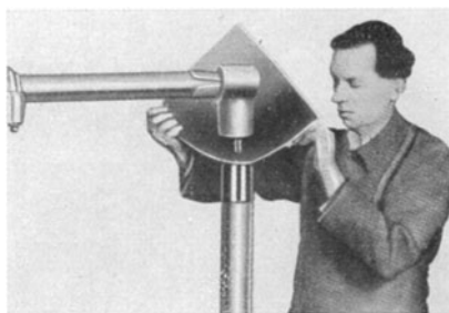
Abb. 1. Mechanischer Treibhammer beim Treiben auf Amboß mit Gummieinlage. ( Joh. Kunz Söhne , Werkzeugmaschinenfabrik, Kronberg/Taunus.)
