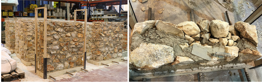
Fig. 1 Construction of the masonry specimens at LERM, IST
