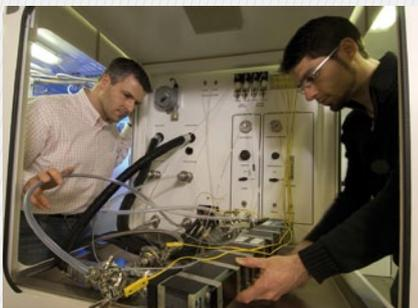
Das Zentrum für Sonnenenergie- und Wasserstoff-Forschung Baden-Württemberg (ZSW) kann nun am Standort **ULM** Brennstoffzellen bis 100 kW Leistung auch nach der Norm DIN EN 62282-2 prüfen. Für diesen Leistungsbereich sei das in Deutschland einzigartig, berichten die ZSW-Experten. Für eine Zertifizierung nach der DIN-Prüfung arbeiten die Ulmer Wissenschaftler mit externen Zertifizierungsstellen zusammen. Über diese Kooperation ist ein
