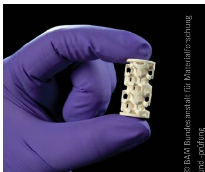
Grünling eines unter Einsatz von Klebstoff mittels 3D-Drucker hergestellten 3D-Gerüsts
