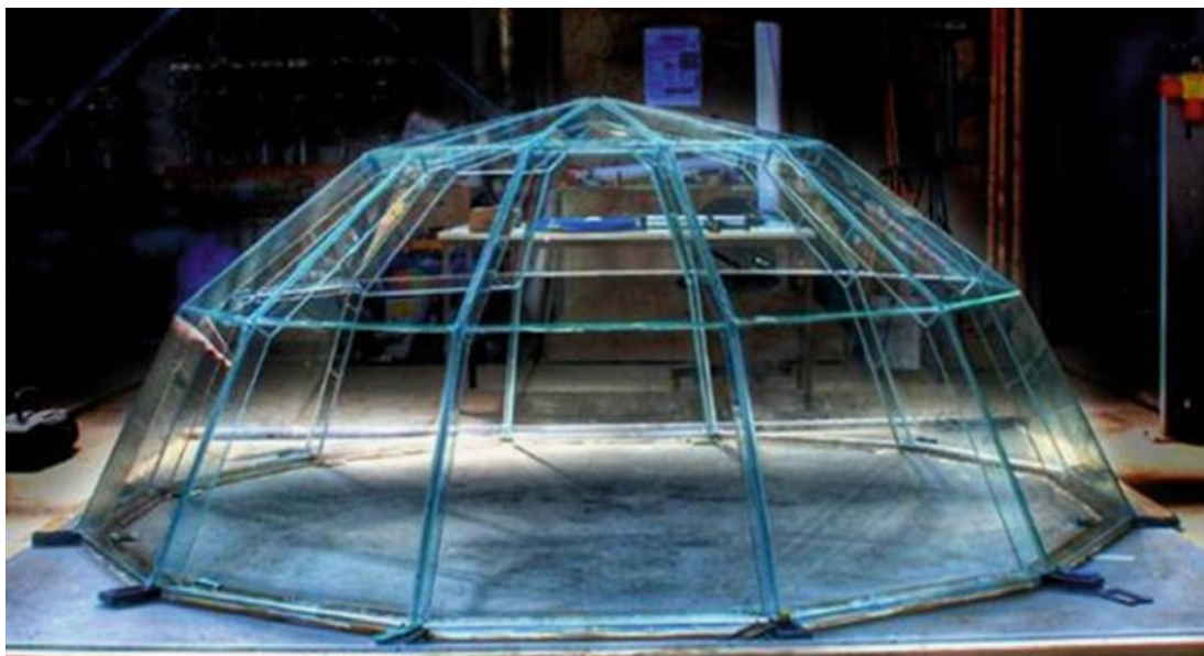
Beispiel einer „geklebten“ Glaskuppel (Bildquelle: Bauhaus-Universität Weimar/Holm Friedrich)
