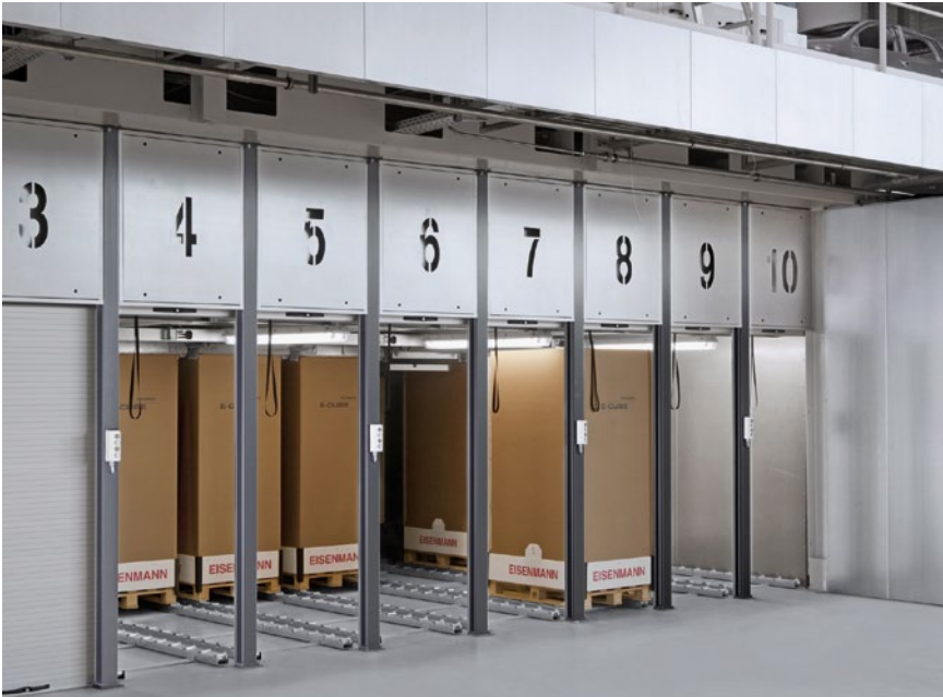
Etkin overspray ayrıştırması için boyama kabini için bir metresi için bir Cube gerekmektedir. Saatte 60 kiloluk overspray miktarında üç vardiyalı işletimde ortalama bir haftalık Cube servisi elde edilmektedir.
