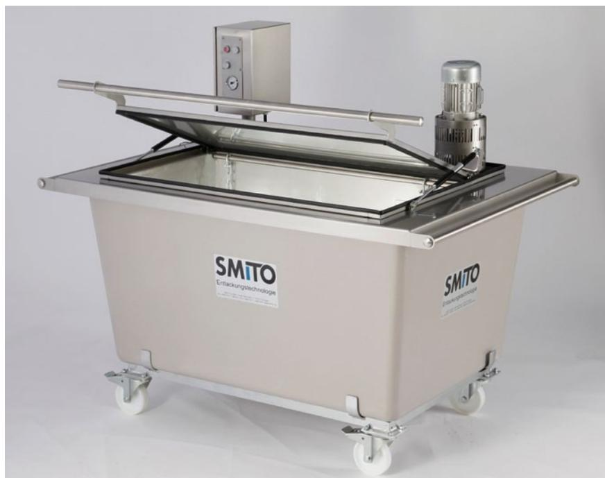
net sich für verschiedene Entlackungsaufgaben, wie zum Beispiel in der Wiederaufarbeitung oder in der Felgenentlackung, bei der Restaurierung von Oldtimern, zur Entlackung von Motor-
