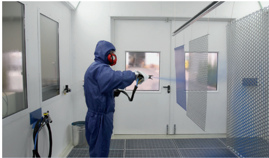
Das neue Technikum ist für die Nasslackierung von Kleinserien und Prototypen ausgelegt
