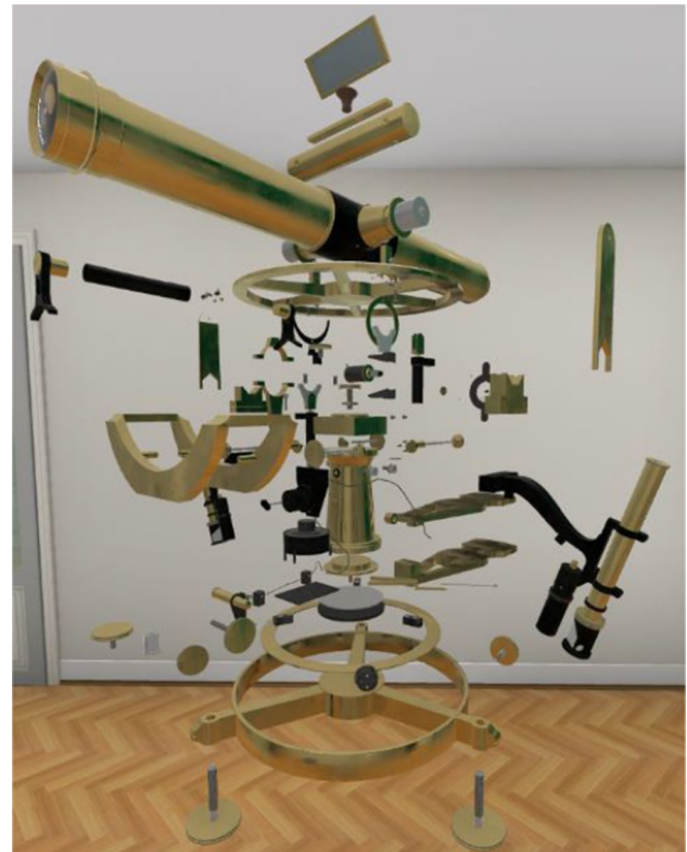
Abb. 3 Historischer Theodolit—LocLab Consulting GmbH (eigene Darstellung)
