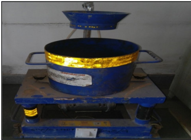
Fig. 4 Vee-Bee degree test
