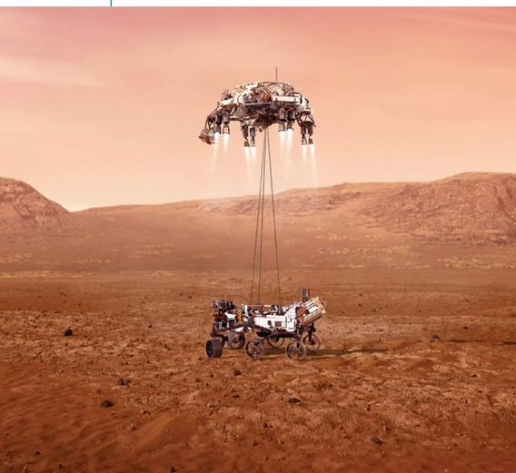
**Bild 1** Mit einem speziellen Transportgerät wird der Mars Rover Perseverance abgesetzt.
