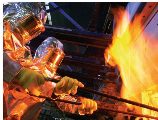
Die Herstellung von Spezialgläsern ist energieintensiv: Sie werden bei Temperaturen von bis zu 1.700 °C geschmolzen. (© Schott)
