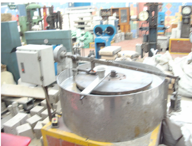
Fig. 2 Abrasion test apparatus.
