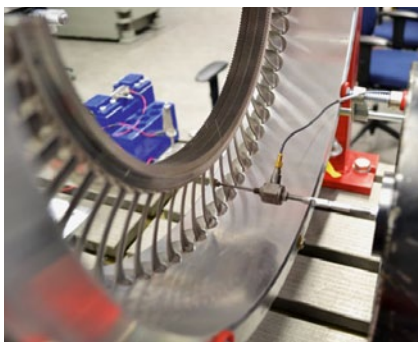
Erregungsmessung am Schaufelkranz (Bild © MTU Aero Engines GmbH)
