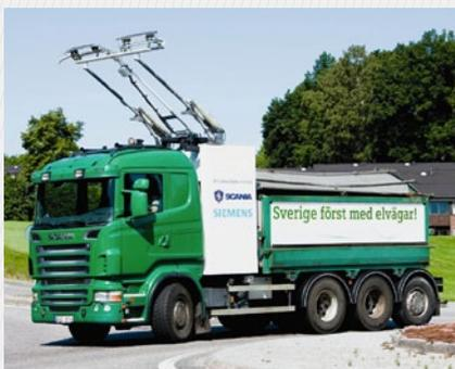
Siemens und der schwedische Nutzfahrzeughersteller Scania haben eine Forschungspartnerschaft beschlossen, in der die Unternehmen gemeinsam Lösungen für einen elektrifizierten Straßengüterverkehr entwickeln wollen. Das Konzept des sogenannten eHighway von Siemens zur Stromversorgung von schweren Lastfahrzeugen über Oberleitungen soll in der Forschungskooperation mit der Expertise zur **ELEKTRIFIZIERUNG** des Antriebsstrangs in Lkw und Bussen von Scania kombiniert werden.
