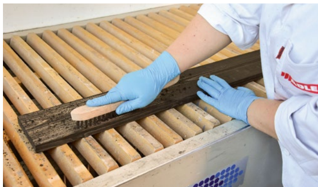
Das feuchte Holz wird nach dem Erstanstrich mit der Drahtbürste aufgeraut und für den Zweitanstrich vorbereitet.
