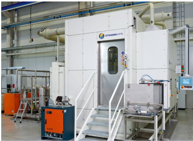
Ein flexibles Reinigungskonzept aus modularer Anlage und Roboterzelle integriert Reinigungsaufgaben mit wässrigen Lösungen in den Gesamtprozess
