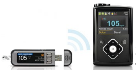
Funkübertragung der Blutzucker-Messwerte an die Insulinpumpe
