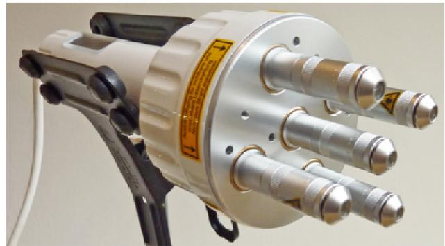
Abb. 1: Der sogenannte 5-Finger-Laser mit ultrakurzen Laserimpulsen
