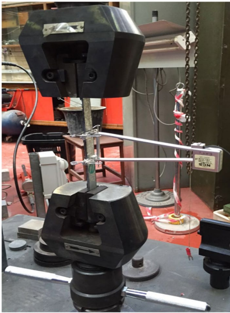
Fig. 4 Tensile test setup
