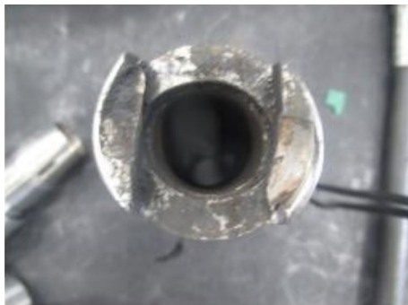
Fig. 14 Worn rod guide (Dove et al. 2016)
