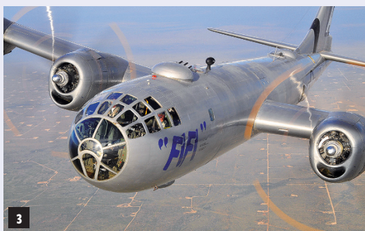
Afb. 3 Veel doorzichtig acryl in de Amerikaanse B-29 bommenwerper die in 1944-1945 in grote getale werd geproduceerd. (Bron: airpowersquadron.org )
