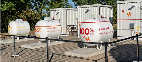
In den Testanlagen prüft Primagas die technischen Voraussetzungen für den Einsatz von regenerativem DME. Denn erneuerbarer DME spart im Vergleich zu fossilen Brennstoffen bis zu 85 % CO<sub>2</sub> ein
