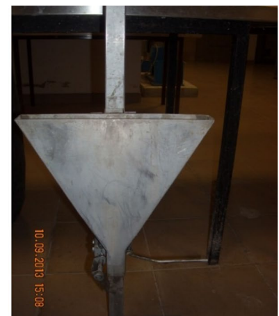
(b) Mini V-funnel apparatus
