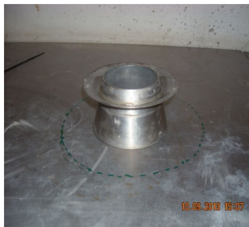
(a) Mini slump cone apparatus
