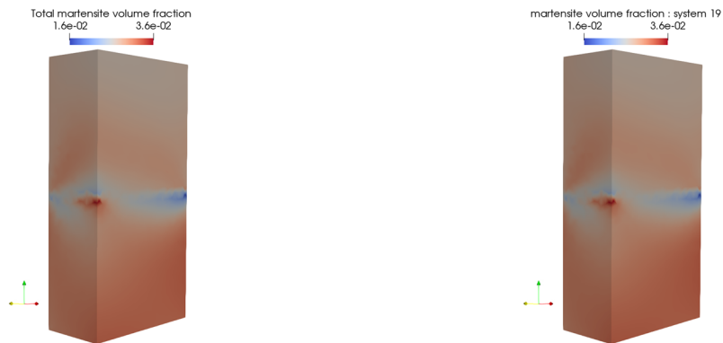
(c) Corresponding total martensite volume fraction (d) Corresponding martensite volume fraction in system 19
