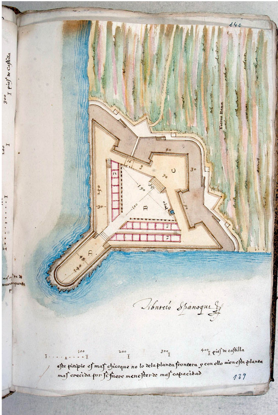
Fig. 1 Historical document showing one of the fortifications planned as part of the Spanish project for the Strait of Magellan “Instrucción para la fábrica de los fuertes que se habían de construir en el Estrecho de Magallanes, Tiburcio Spanoqui”(AMN0021.MS0029-015 AMN 0021, Archivo del Museo Naval, Madrid, Spain)
