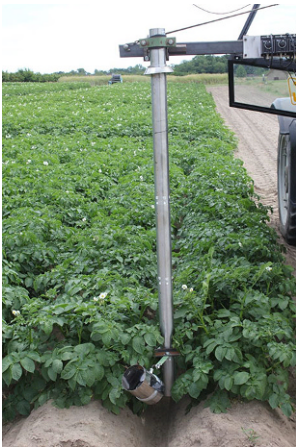
Abb. 3 Nikon 1J3 Kamera (Aufnahmerichtung seitlich schräg nach hinten/oben) in einem Schutzgehäuse in der Kartoffelreihe an einer vertikalen Edelstahlstange (Vertikalsensor) am Heckdreipunkt des JCB-Traktors während der Messfahrt im Test 2022
