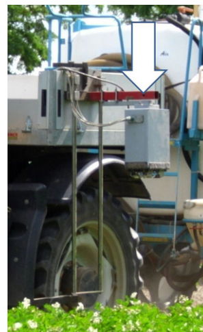
Abb. 1 Höhenverstellbar aufgehängte Multispektralkamera im Gehäuse (Pfeil), seitlich an der Pritsche des JCB-Traktors im Test 2012. (Nach Dammer et al. 2016a)
