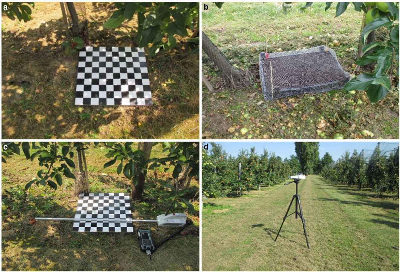
Abb. 2 a Bestimmung der Lichtverfügbarkeit mit der point quadrat method unter Apfelbäumen am Campus Klein-Altendorf ( links oben ); b Keimtest mit dem Lichtkeimer Kresse ( Lepidium sativum ) und dem Dunkelkeimer Borretsch ( Borago officinalis ) unter den ‚Elstar‘-Apfelbäumen ( rechts oben ); c Position des Ceptometers auf dem Schachbrett zur Messung der Lichteinstrahlung im Baumstreifen ( links unten ); d Referenzsensor für die Ceptometer-Messungen am Ende der Baumreihe ( rechts unten )
