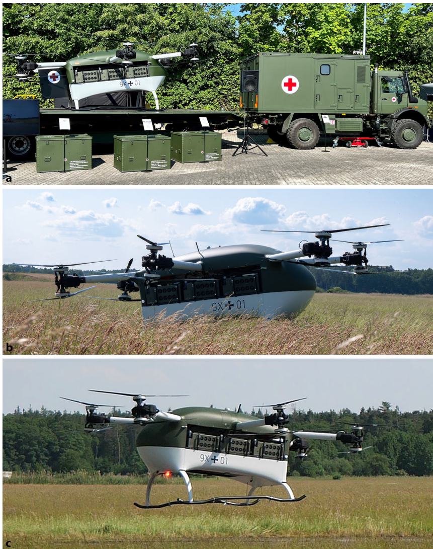
Abb. 2 ▲ a Der Prototyp, im Gespann zu sehen. Diese Konfiguration erlaubt die rasche Verlegung und somit maximal flexible Einsatzkonfigurationen. b Im gelandeten Zustand. c im Anflug; © all rights reserved, Mit freundlicher Genehmigung der AVILUS GmbH
