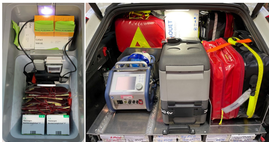
Abb. 5 ▲ Blutkühlschrank des MIC mit Blutprodukten und Temperaturmessung. Position des Kühlschranks im Fahrzeug zwischen dem Cardiohelp-System der Firma Getinge AB, Stockholm, Schweden, und dem speziellen Trauma-/Transfusionsrucksack von PAX, X-CEN-TEK GmbH, Wardenburg, Deutschland
