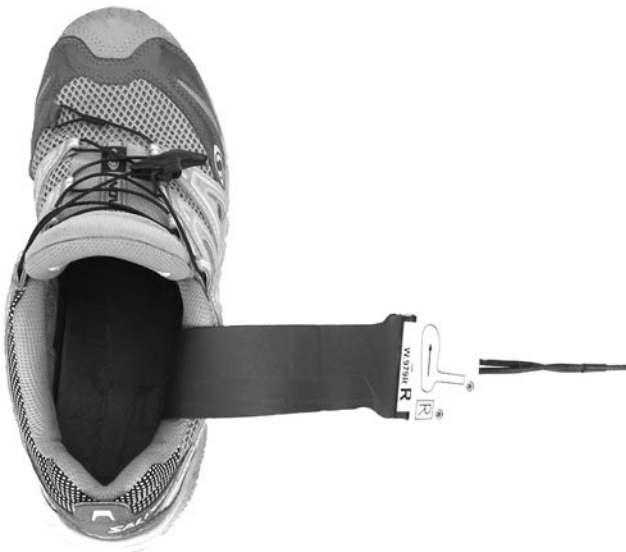
Abb. 2 ◀ Portables Messsystem: Messsohle im Schuh
