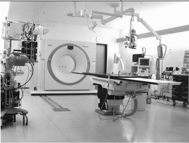
Abb. 1 ◀ Schockraum mit MSCT mit „sliding gantry“ (Somatom-16-Sensation, Fa. Siemens Medical Solutions, Erlangen)
