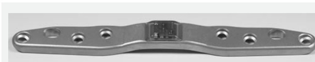
Abb. 1 ▲ Mit Miniaturtelemetrie instrumentierter Femurfixateur interne
