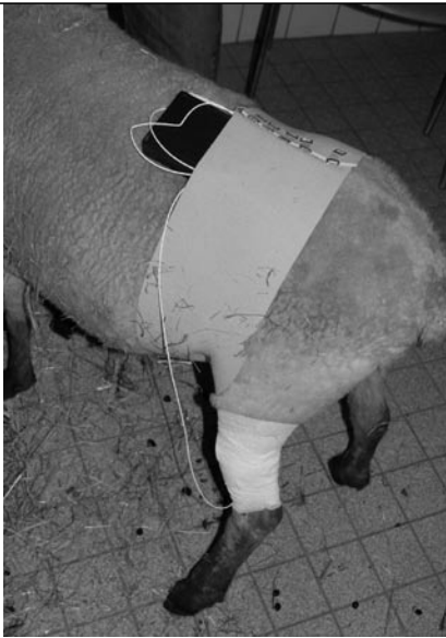
Abb. 2 ▲ Entwickelte Leseinheit mit Bluetooth-Funkübertragung, als „Rucksacksystem“ Möglichkeit kontinuierlicher Messungen über Funkverbindung bei frei laufendem Tier
