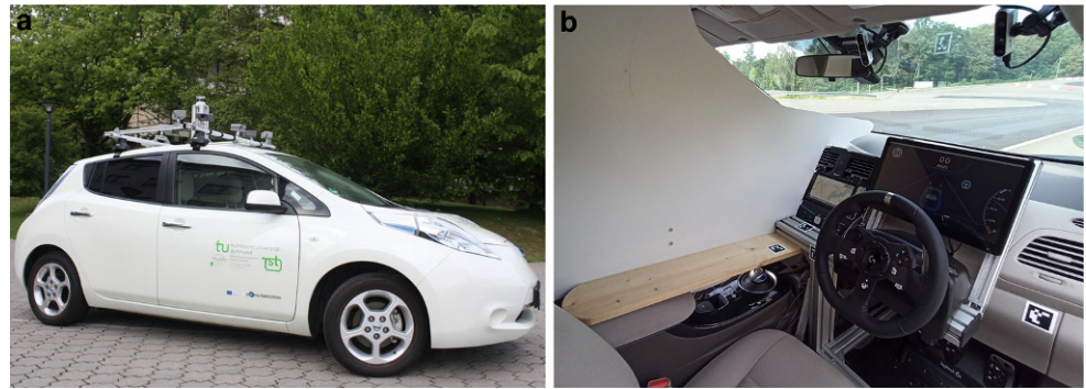
Abb. 3 Versuchsfahrzeug: Elektrisch angetriebener Nissan Leaf. a Versuchsfahrzeug mit Dachaufbau, b Fahrersitz für den Probanden im Versuchsfahrzeug
