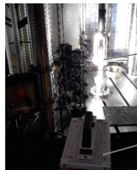
Versuchsaufbau Drahtziehvorrichtung in der Hochgeschwindigkeitsprüfmaschine Ziehgeschwindigkeit 2000 mm/s
