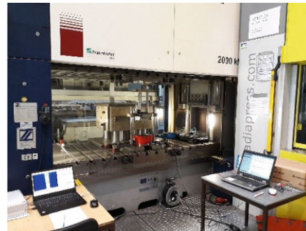
Versuchsaufbau Drahtziehvorrichtung in der Servopresse Ziehgeschwindigkeit 20 mm/s
