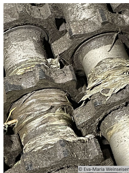
Abb. 1 Vorsammelhilfen als Störfaktor beim Sternsieb einer Bioabfallbehandlungsanlage
