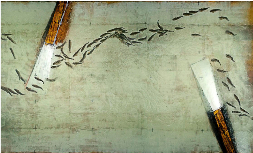
Abb. 14 1:1-Versuche mit Fischen zum Nachweis der Fischdurchgängigkeit im Wienfluss infolge Errichtung von optimierten Buhnen. (Sindelar et al. 2024b)
