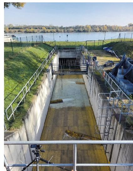
**Abb. 6** Versuchssetup der ethohydraulischen 1:1-Versuche im Forschungserinne des BOKU-Wasserbaulabors, Fließrichtung von oben nach unten, im weiß ausgemalten Bühnenfeld zwischen den Bühnen zwei und drei wurde die Fischwanderung mittels zwei Kameras dokumentiert
