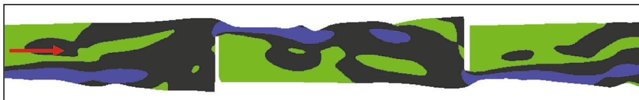
Abb. 4 Zonen bei  $Q_{330}$  einer Bühnenvariante mit  $\alpha = 90^\circ$ ,  $H = 0,5 \text{ m}$ ,  $L = 5,4 \text{ m}$ ,  $D = 20 \text{ m}$ . Fließrichtung von links nach rechts. Wanderkorridor (schwarz), Ruhezonen (grün), überhöhte Geschwindigkeit (blau), zu geringe Wassertiefe (weiß, hier nicht vorhanden), aus: Lasinger und Leutgöb (2022)
