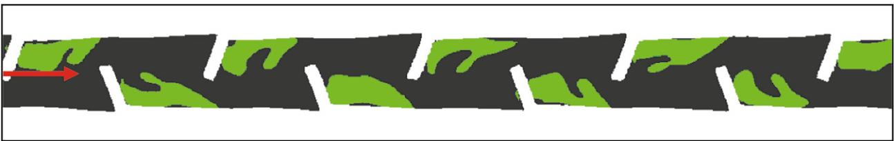
**Abb. 5** Zonen bei  $Q_{330}$  des Ausführungsvorschlags mit  $\alpha = 70^\circ$ ,  $H = 0,2$  m,  $L = 4,0$  m,  $D = 6$  m. Fließrichtung von links nach rechts. Wanderkorridor (schwarz), Ruhezone (grün), überhöhte Geschwindigkeit (blau, hier nicht vorhanden), zu geringe Wassertiefe (weiß), aus: Lasinger und Leutgöb (2022)
