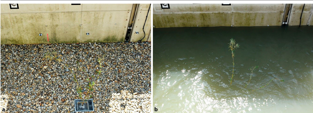
Abb. 4 a In die Kraftaufnehmerbox eingebaute Korbweide ( Salix viminalis ), b Messung der Strömungskraft bei Anströmung
