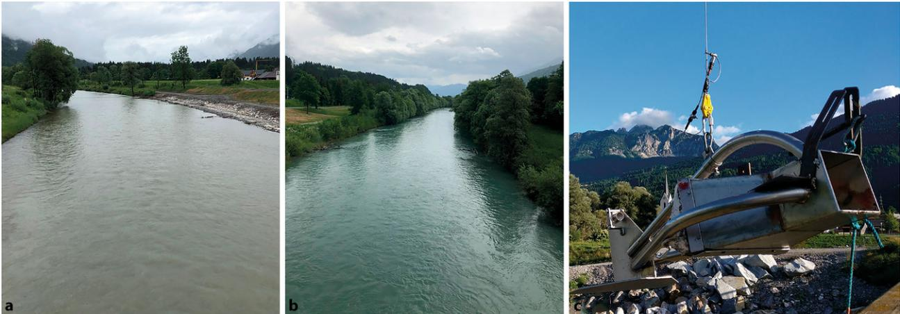
**Abb. 3** Übersicht der Geschiebemesstation 1 an der Oberen Gail (a), der Geschiebemesstation 2 an der Mittleren Gail (b) mit jeweils Blick flussab und der LHS-Geschiebesammler im Messeinsatz (c)
