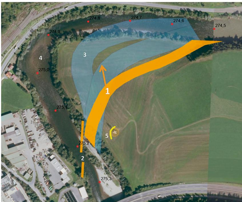
**Abb. 8** Konzeptioneller Maßnahmenvorschlag für eine innovative „Redynamisierung“ dargestellt am Beispiel der Oberen Mur direkt flussab von St. Michael in der Obersteiermark (orange 1: Aushub eines Initialgerinnes, orange 2: Ablenk- und Fangbuhne für Umlenkung der Strömung, hellblau 3: Phasen der langfristigen Gerinneverlagerung, bestehendes Flussbett (Orthofoto) 4: späterer Neben- oder Altarm, gelb 5: lokaler Schutz von Infrastruktur)
