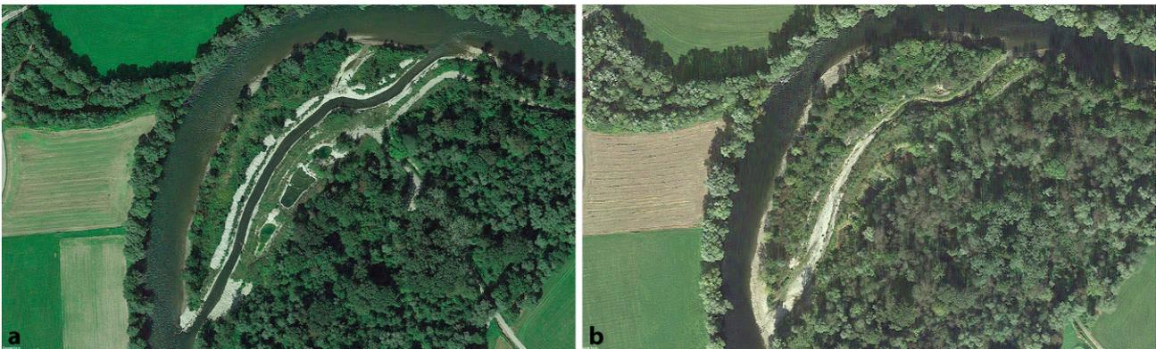
**Abb. 7** Vergleich des 2014 neu angelegten Nebenarms bei Feistritz-St. Lorenzen im August 2015 (a) bei einem Abfluss von  $44 \text{ m}^3/\text{sec}$  (76 % MQ) mit dem Zustand im September 2021 bei  $34 \text{ m}^3/\text{sec}$  (59 % MQ; b). Wenn auch die Abflusssituationen nicht ganz vergleichbar sind, so ist eine zunehmende Verlandung im Nebenarm ersichtlich (Google Earth, Landsat/Copernicus)
