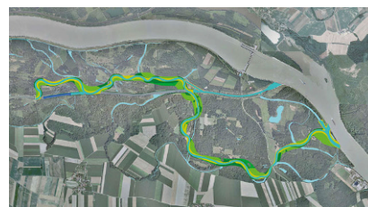
Abb. 8 Überblick über die „neu errichtete Traisen“ (blau: MW-Bett, braun: HQ-Bett, hellgrün: Umlandabsenkungen, dunkelgrün: Pufferzonen)
