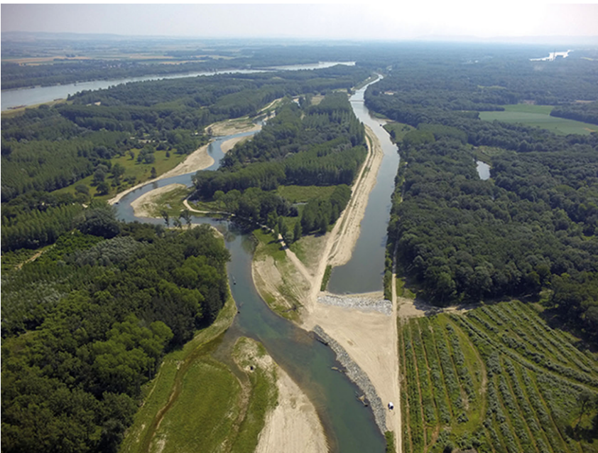
Abb. 10 Oberer Teil des mittleren Bauabschnitts sowie Ableitungsbauwerk und bestehende („alte“) Traisen ca. 3 Monate nach Flutung (Foto: G. Pock)
