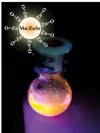
**Abb. 3** An der BOKU synthetisierte QDs (mit fluoreszierendem Kern aus Mn:ZnSe), welche mit einer ZnO-Oberfläche modifiziert wurden, um handelsübliche (aber in der Umwelt schwer wiederauffindbare) ZnO Nanopartikel so gut wie möglich nachahmen und nachverfolgen zu können
