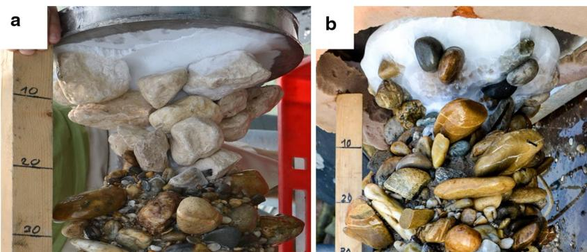
**Abb. 10 a** geologischer Tracer (Fremdgesschiebe) 4 Wochen nach Einbau, **b** GSV 32/120 rund 1 Jahr nach Einbau
