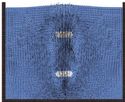
**Abb. 7** Mehrskaliges SPH-Modell einer Luftsäule mit homogener Luftblasenverteilung. Eine Einzelblase wird durch 66 SPH-Partikel mit einer experimentell vorgegebenen Aufstiegs geschwindigkeit charakterisiert, sodass 5 min. physikalischer Zeit in 5 h simuliert werden können
