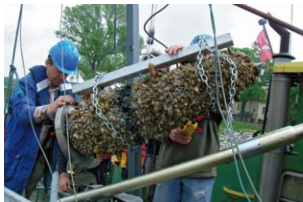
Mittels Freeze-Core-Beprobungen wird die Korngrößenzusammensetzung der Stromsohle dokumentiert
