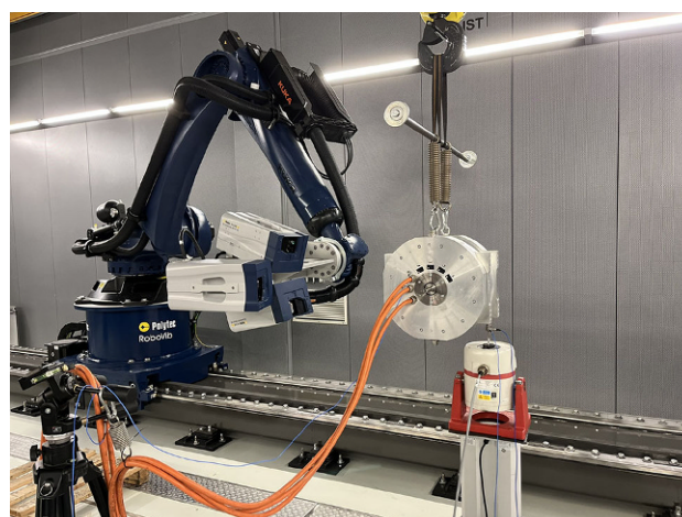
Abb. 4 Versuchsaufbau der experimentellen Modalanalyse im RoboVib-Testzentrum
