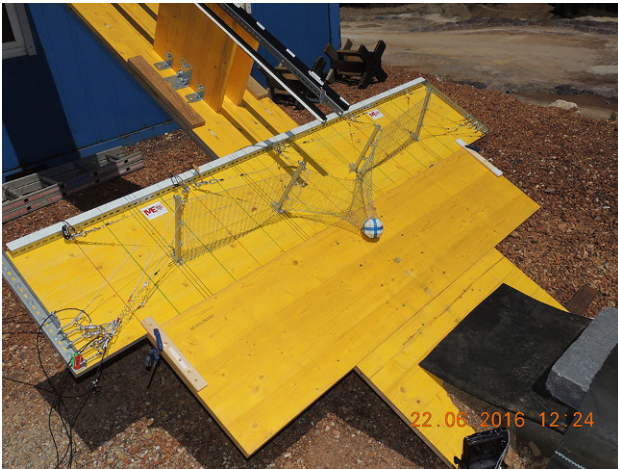
Abb. 2: Modellierung des Systems TSC-2000-ZD auf einer schrägen Prüf-anordnung (mit Referenzgeländeneigung von 30°)
