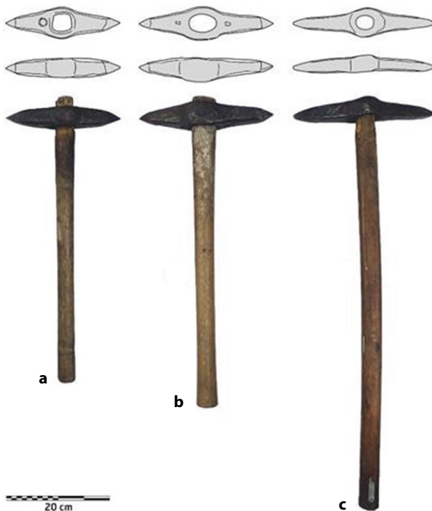
Abb. 2: Drei historische Doppelspitzschlägel („Zwoaspitz“) aus der Saline Aussee (mit der Draufsicht und dem Querschnitt), vermutlich 19./20. Jahrhundert; Sammlung „Steirisches Salz“ in Schloss Trautenfels, Universalmuseum Joanneum: a Inv.-Nr. 11.323; b Inv.-Nr. 14.684, c Inv.-Nr. 11.270. (Foto/Grafik: D. Modl)
