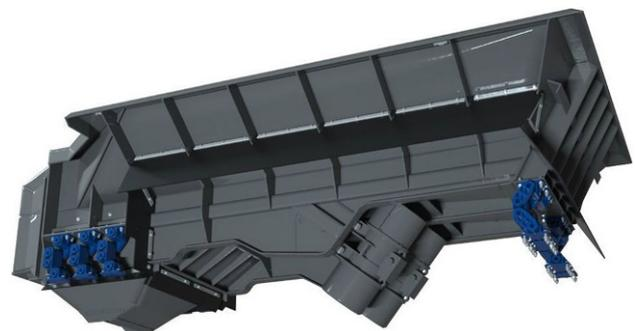
Abb. 6: Vibrorinne mit Unwuchtmotoren [5]
