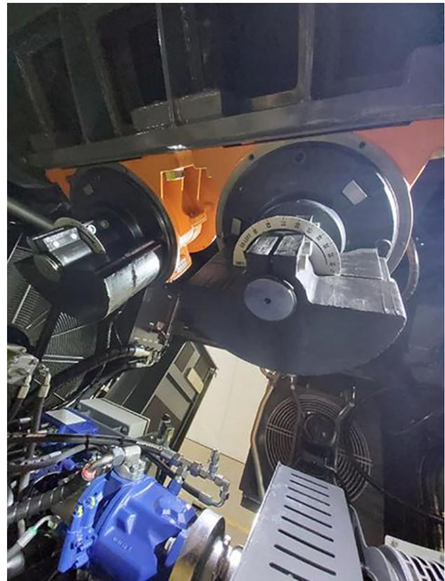
Abb. 5: Unwuchtmotoren mit der Einstellung 100% Unwucht
